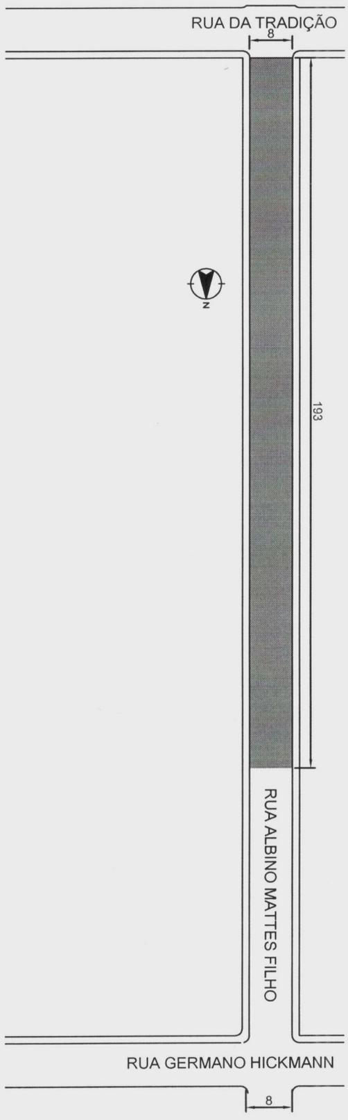
**REVESTIMENTO COM C.B.U. Q SOBRE PAVIMENTAÇÃO POLIÉDRICA**
