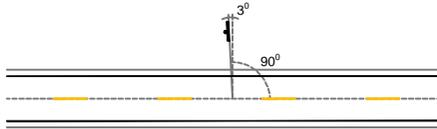
CORREÇÃO ANGULAR PARA EVITAR OFUSCAMENTO SEM ESCALA
